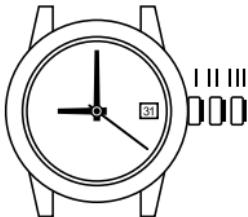
В положении головки III прерывается питание от батарейки. Вращая головку, Вы изменяете текущее время на Ваших часах. Секунды можно синхронизировать с официальным сигналом точного времени по радио или ТВ. Для этого дождитесь, пока секундная стрелка не достигнет положения «12 часов», затем вытащите головку, установите нужное время и переведите головку в первоначальное положение I в момент передачи сигнала точного времени.
