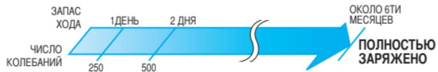
1. Если часы остановились, или если Вы заметили, что секундная стрелка движется с интервалом в 2 секунды, покачайте часы из стороны в сторону с частотой 2 раза в секунду.
