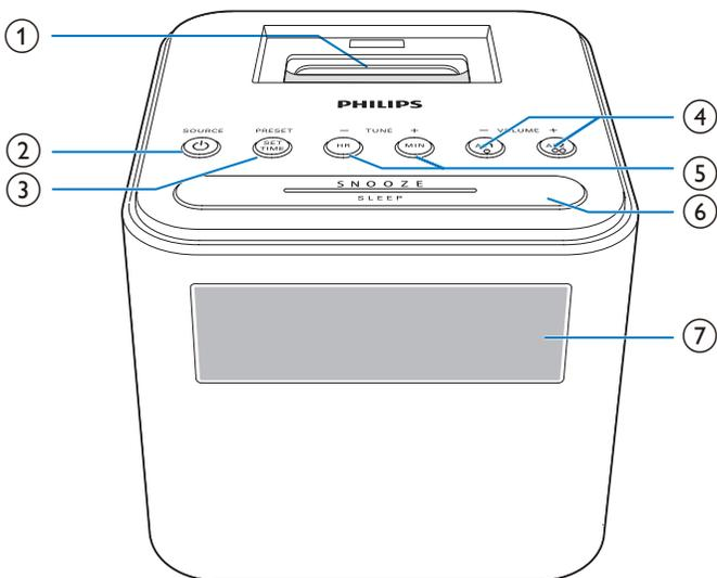
① Док-станция для зарядки мобильных устройств
