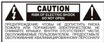
Молния с символом стрелы внутри равнобедренного треугольника предназначена для того, чтобы предупредить пользователя о наличии неизолированного “опасного напряжения” внутри корпуса продукта, которое может быть достаточным для того, чтобы создать риск поражения людей электрическим током.
