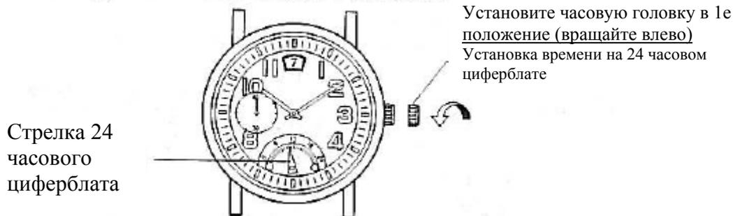
24 часовой циферблат позволяет установить время другой часовой зоны.
