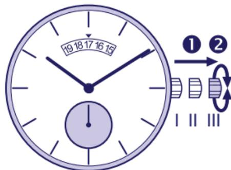
**1** Вытяните заводную головку до положения III, секундная стрелка остановится (установка времени "с точностью до секунды").
