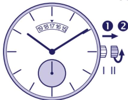
**1** Вытяните заводную головку до положения II (часы продолжают идти).
