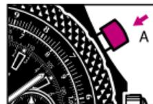
2. Fermare la misurazione premendo di nuovo il pulsante **A**. La misura si effettua in ore (totalizzatore **1**), in minuti (totalizzatore **2**), in secondi e in ottavi di secondo (lancetta **3**).
