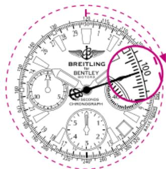
N.B. Esta escala taquimétrica, utilizada em conjunto com o cronógrafo «30 segundos», é especialmente adaptada à medição de velocidades elevadas situadas entre os 95 km/h (ou mph) e 320 km/h (ou mph). Por conseguinte, o tempo de observação é limitado de 11 a 38 segundos.
