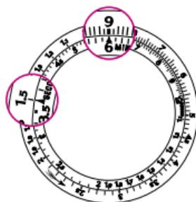
**Taux de production ou de consommation horaire:** la mesure d'un taux de production, ou d'une consommation horaire s'effectue selon le même principe que la mesure d'une vitesse moyenne. Par exemple, si une machine débite 15 unités en 45 secondes, quelle est sa production horaire?
