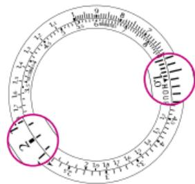
**比例法：**两个比例尺可进行乘法的连续计算。例如，1.5公尺电缆的价格为9英镑，计算6公尺电缆的价格只需将9对准数字6即可。1.5对准的数字36即为结果。
