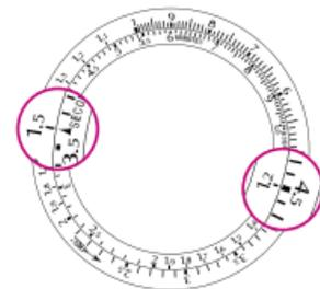
**Beispiel 2:** Legt ein Fahrzeug in 1 Minute und 30 Sekunden (= 90 Sekunden) 4,5 km zurück, welches ist seine mittlere Geschwindigkeit?
