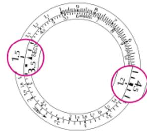
**脈搏測量：**脈搏測量：這一功能可快速測出脈搏次數。如脈搏在24秒內跳動27次，只需將數字27（脈搏跳動次數）置於分鐘標記（MINUTES）的位置，24（跳動時間）所對準的數字即為測量結果：每分鐘脈搏跳動67次。
