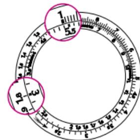
**Division:** la division est l'inverse de l'exemple précédent. Pour diviser 54 par 2, il suffit de placer le chiffre 54 en regard du repère HOURS de l'échelle fixe ou du chiffre 1 du disque mobile. Le résultat se lit à l'opposé du chiffre 2 de l'une ou l'autre échelle. Cette unique opération produit une table complète de division du chiffre 54:
