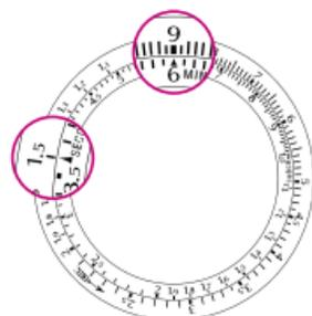
**每小时生产量或消耗量：**计算每小时产量或消耗量的方法与计算平均速度的方法相同。例如，某设备每45秒钟生产15个零件，每小时产量为多少？
