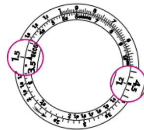
**Pulsomètre:** le pulsomètre permet le calcul rapide du pouls. Par exemple, si 27 pulsations sont mesurées dans une période de 24 secondes, il suffit de placer le chiffre 27 (nombre de pulsations) en face du repère MINUTES, puis de lire le résultat en face du chiffre 24 (durée d'observation), soit 67 pulsations par minute.
