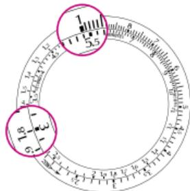
**割り算：**54を2で割るには、回転目盛の5.4（54）を固定目盛の▲HOURSに合わせるか、固定目盛の5.4（54）を回転目盛の1に合わせます。そのとき回転目盛の2に対応する固定目盛の数値2.7（27）、または固定目盛の2に対応する回転目盛の数値2.7（27）から計算結果が得られます。同時に54を他の数字で割った計算結果も直ちに得ることができます。
