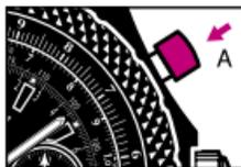
2. 欲結束計時，再次按下A鈕即可。計時的結果以小時（1號彙計器）、分鐘（2號彙計器）、秒鐘與八分之一秒單位（3號指針）顯示於錶面。
