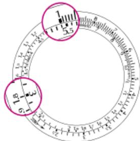
除法：除法計算與上述方法相反。如將54除以2，只需將54放置在固定比例尺的小時標記（HOURS）或移動比例尺上數字1的位置。兩個比例尺上的數字2對面指示的即為計算結果。這種獨特計算方法還可提供整除54的除法表，即：
