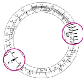
**Regole del tre:** le due scale permettono di concentrare in un'unica operazione una moltiplicazione e una divisione. Esempio: per determinare il prezzo di 6 metri di cavo, se 1,5 metri costano £ 9.00, basta portare la cifra 9 di fronte alla cifra 6. Il risultato figura di fronte alla cifra 1.5 ed è pari a £ 36.00.
