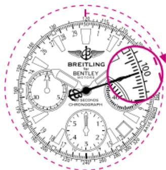
N.B. Questa scala tachimetrica, usata in coppia con il cronografo «30 secondi», è particolarmente adatta a misurare velocità elevate, fra i 95 km/h (o mph) e i 320 km/h (o mph). Di conseguenza il tempo di osservazione dev'essere compreso fra 11 e 38 secondi.
