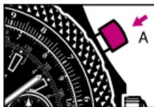
2. Arrêter la mesure en appuyant à nouveau sur le poussoir **A**. La mesure s'effectue en heures (compteur **1**), minutes (compteur **2**), en secondes et  $\frac{1}{8}^e$  de seconde (aiguille **3**).
