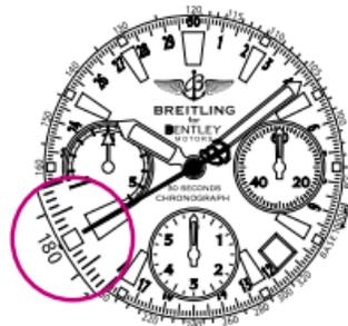
*Exemple 2: S'il faut 36 secondes pour parcourir un kilomètre ou un mile, la vitesse moyenne est de 100 km/h, respectivement 100 mph.*
