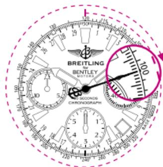
注意：測速標度盤的比例尺應與「30秒」計時碼錶結合使用，專用於測量95公里/小時（或英里/小時）和320公里/小時（或英里/小時）之間的高速，測量時間限於11秒到38秒之間。
