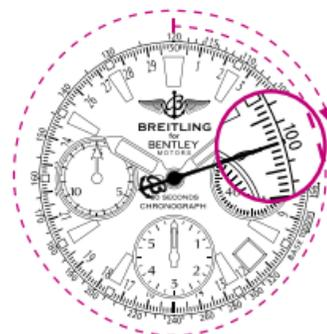
N.B. Utilizada conjuntamente con el cronógrafo «30 segundos», esta escala taquimétrica facilita la medida de velocidades situadas entre 95 km/h (o mph) y 320 km/h (o mph). Por consiguiente, el tiempo de observación se situará entre 11 y 38 segundos.
