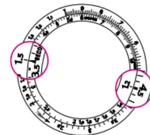
**Exemple 2:** si un véhicule parcourt 4,5 km (ou 4,5 miles) en 1 minute 30 secondes (= 90 secondes), quelle est sa vitesse moyenne?
