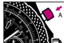
2. Interromper a medição pressionando novamente o pistão **A**. A medição é efectuada em horas (contador **1**), minutos (contador **2**), em segundos e em  $\frac{1}{8}$  de segundo (ponteiro **3**).
