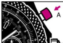
2. Остановка хронографа: Еще раз нажмите на кнопку **A**. Показания об измеряемом отрезке времени можно прочитать: в часах (счетчик **1**), в минутах (счетчик **2**), в секундах и в 1/8 секунды (стрелка **3**).
