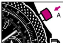
2. Zum Stoppen der Messung erneut Drücker **A** betätigen. Die Messung erscheint in Stunden (Zähler **1**), Minuten (Zähler **2**), Sekunden und  $\frac{1}{8}$ -Sekunden (Zeiger **3**).
