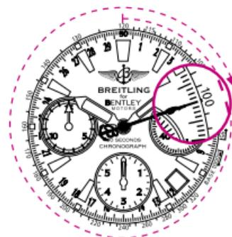
N.B. Cette échelle tachymétrique, utilisée en conjonction avec le chronographe «30 secondes», est spécialement adaptée à la mesure de vitesses élevées situées entre 95km/h (ou mph) et 320 km/h (ou mph). Par conséquent, le temps d'observation est limité de 11 à 38 secondes.
