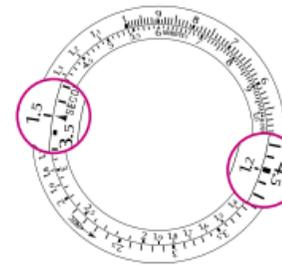
**脉搏测量：**脉搏测量：这一功能可快速测出脉搏次数。如脉搏在24秒内跳动27次，只需将数字27（脉搏跳动次数）置于分钟标记（MINUTES）的位置，24（跳动时间）所对准的数字即为测量结果：每分钟脉搏跳动67次。
