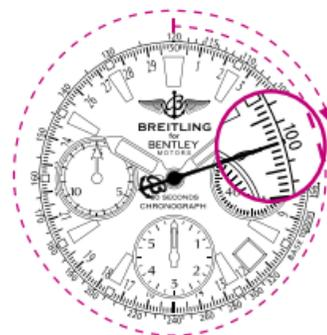
Примечание: Данная тахиметрическая шкала и 30-секундный хронограф предназначены для измерения высоких скоростей (95 – 320 км / час или миль / час). Поэтому диапазон измерений ограничен на отрезки времени от 11 до 38 секунд.
