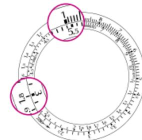
**Деление:** Деление осуществляется в обратном порядке по сравнению с умножением. Чтобы разделить 54 на 2 следует поместить цифру 54 напротив отметки HOURS на неподвижной шкале или у цифры 1 на мобильной шкале. Результат считывается напротив цифры 2 на одной из этих шкал. Эта простая операция приносит следующие результаты при делении цифры 54:
