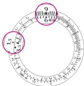
**每小時生產量或消耗量：**計算每小時產量或消耗量的方法與計算平均速度的方法相同。例如，某設備每45秒鐘生產15個零件，每小時產量為多少？
