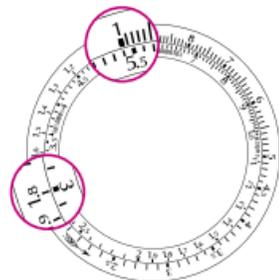
**División:** la división se efectúa al contrario que la multiplicación. Para dividir 54 entre 2, basta con colocar la cifra 54 enfrente de la indicación HOURS de la escala fija o de la cifra 1 del disco móvil. El resultado aparece indicado enfrente de la cifra 2 de una u otra escala. Con esta única operación se obtiene una tabla completa de división de la cifra 54:
