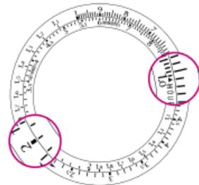
**Regla de tres:** las dos escalas permiten realizar una multiplicación seguida de una división en una sola operación. Por ejemplo, para determinar el precio de 6 metros de cable si 1,5 metros cuestan £ 9.00, basta con colocar la cifra 9 enfrente de la cifra 6. El resultado aparece indicado enfrente de la cifra 1.5, es decir £ 36.00.
