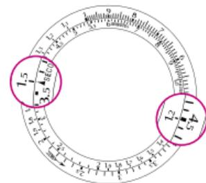
**Пульсометр:** пульсометр позволяет сделать быстрый расчет пульса. Например, если 27 ударов сердца было сделано за 24 секунды, то для получения результата следует поместить цифру 27 (количество ударов) напротив отметки MINUTES и затем считать результат напротив цифры 24 (время), в данном случае это 67 ударов в минуту.
