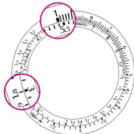
**Divisione:** la divisione è l'operazione inversa alla precedente. Per dividere 54 per 2 basta portare la cifra 54 di fronte al rèpere HOURS della scala fissa o alla cifra 1 del disco mobile. Il risultato si legge di fronte alla cifra 2 dell'una o dell'altra scala. Con quest'unica operazione si ottiene una tavola completa di divisione della cifra 54:
