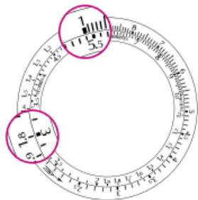
**除法：**除法计算与上述方法相反。如将54除以2，只需将54放置在固定比例尺的小时标记（HOURS）或移动比例尺上数字1的位置。两个比例尺上的数字2对面指示的即为计算结果。这种独特计算方法还可提供整除54的除法表，即：
