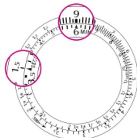
**Tassi di produzione o di consumo orario:** per calcolare un tasso di produzione oraria o di consumo orario si applica lo stesso principio impiegato per misurare una velocità media. Esempio: se una macchina sforna 15 pezzi in 45 secondi, quale sarà la sua produzione oraria?
