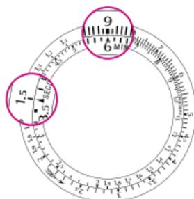
**Производительность или потребление в час:** расчет производительности или потребления в час соответствует принципам расчета средней скорости. Например, если станок производит 15 единиц продукции за 45 секунд, какова его производительность в час?
