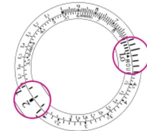
**Dreisatz:** Mit den beiden Skalen kann in einer einzigen Operation eine Multiplikation gefolgt von einer Division durchgeführt werden. Um beispielsweise den Preis von 6 Meter Kabel zu berechnen, wenn 1,5 Meter £ 9.00 kosten, die Ziffer 9 gegenüber der Ziffer 6 stellen. Das Resultat £ 36.00 steht gegenüber der Ziffer 1.5.
