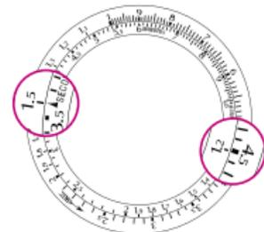
**Pulsometer:** Mit dem Pulsometer kann die Pulsfrequenz schnell berechnet werden. Wenn z.B. 27 Pulsschläge in 24 Sekunden gemessen werden, die Ziffer 27 (Pulsschläge) gegenüber der Markierung MINUTES stellen und danach das Resultat (67 Pulsschläge pro Minute) gegenüber der Ziffer 24 (Messdauer) ablesen.
