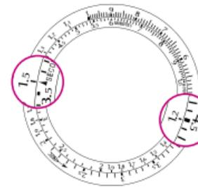
**解答：**回転目盛の1.5（生産個数15個）を、固定目盛の▲SECONDSに合わせます。回転目盛の4.5（45秒）に対応する固定目盛の数値を読めば、1.2（毎時1,200個）が得られます。
