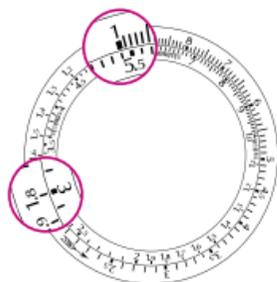
**Divisão:** a divisão é o inverso do exemplo anterior. Para dividir 54 por 2, é suficiente colocar o número 54 olhando para a marca HOURS da escala fixa ou do número 1 do disco móvel. O resultado lê-se no oposto do número 2 de uma ou de outra escala. Esta única operação produz um quadro completo da divisão do número 54:
