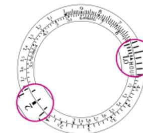
**Правило трех:** обе шкалы позволяют производить умножение и потом деление в одной операции. Например, для определения стоимости 6 метров кабеля при стоимости 1,5 метров 9 фунтов, следует поместить цифру 9 напротив цифры 6. Результат считывается напротив цифры 1,5, в данном случае 36 фунтов.
