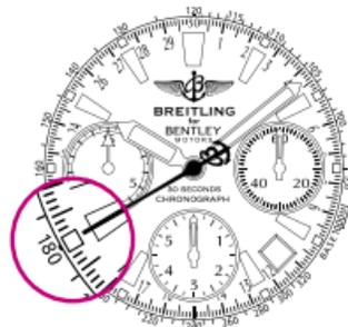
*Ejemplo 2:* si se invierten 36 segundos en recorrer un kilómetro o una milla, la velocidad media será de 100 km/h o de 100 mph respectivamente.
