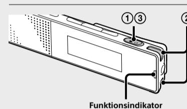
Innan du börjar använda IC-inspelaren, se till att du skjuter POWER•HOLD-omkopplaren mot mitten för att frigöra statusen HOLD.
