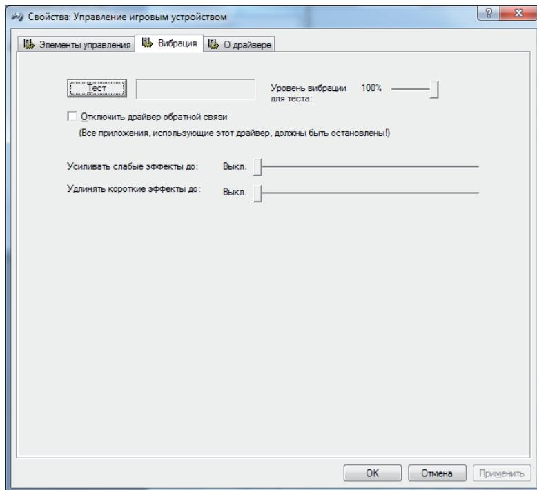
На этой вкладке Вы можете протестировать работу вибромоторов (кнопка «Тест») с различной интенсивностью (при помощи «движка» «Уровень вибрации для теста»).
