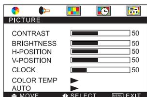
В режиме подключения к компьютеру (VGA) нажмите кнопку Setup для вызова меню настройки параметров подключения
