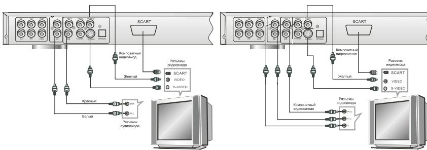
Подключение видеовыхода устройства к S-Video видеовходу телевизора (CVBS, S-Video или Y/Cb/Cr).
