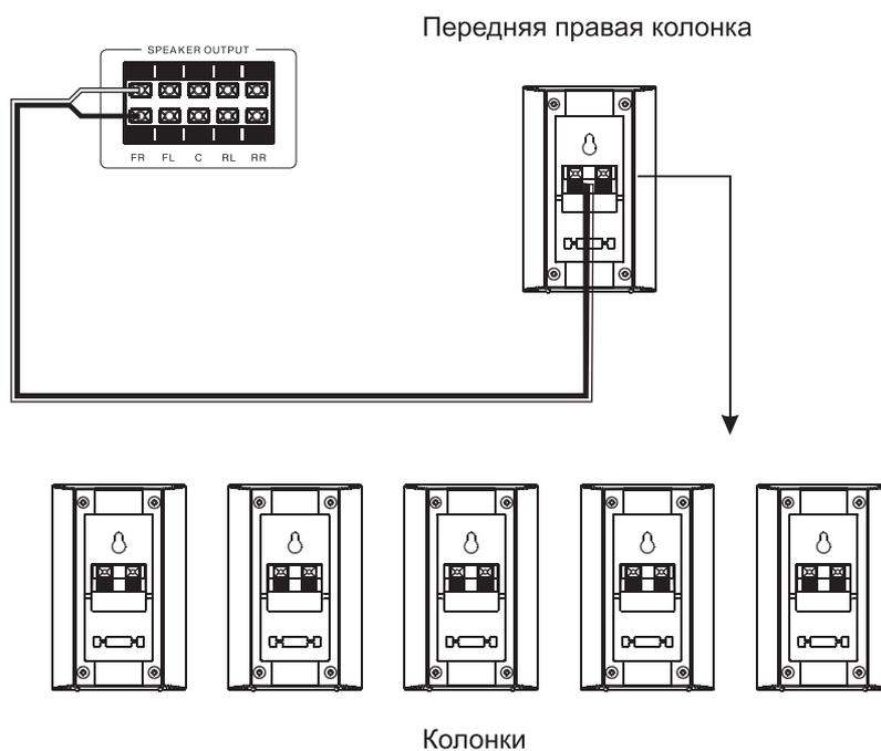
Примечание: при подключении колонок соблюдайте полярность, подключая красный разъем колонки к красному разъему задней панели устройства, а черный разъем - к черному.
