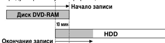
Для пользования функцией Последовательной записи установите «Последовательную запись» в положение «On» (☞ стр. 160).
