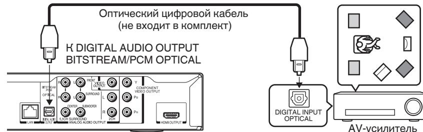
\* Для использования оптического цифрового выхода воспользуйтесь оптическим кабелем и вставьте его разъем в оптический аудиовыход устройства, способного обрабатывать Dolby Digital, DTS bitstream или PCM аудио.
