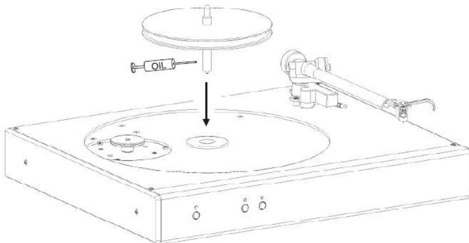
4. Расположите середину диска шпинделя в сердцевине подшипника, поворачивая и слегка прижимая его вниз, в то же время, пожалуйста, позаботьтесь, чтобы держать диск горизонтально; шпиндель должен мягко скользить в сердцевину подшипника.
