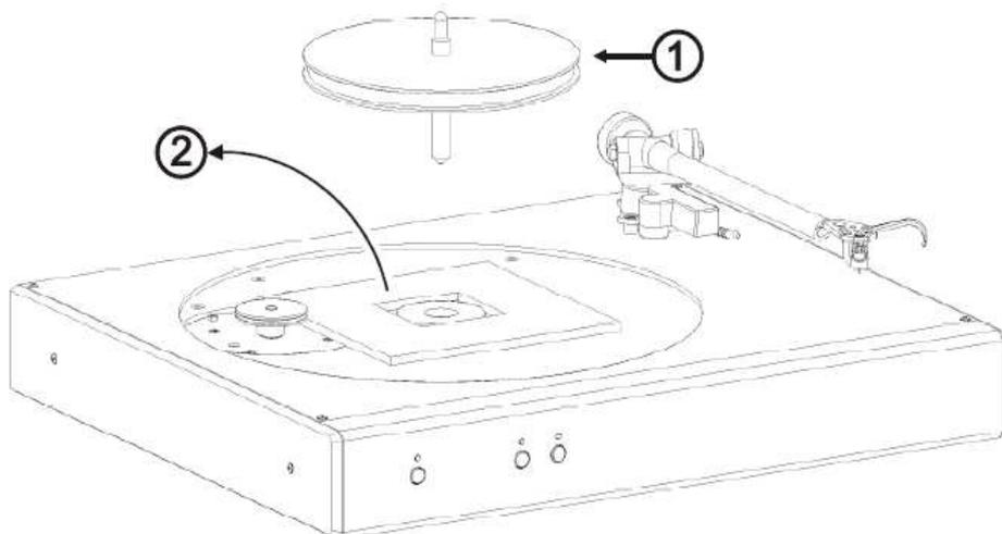
3. Аккуратно смажьте маслом отступы на шпинделе на жестком диске и подшипников с использованием шприца в комплект поставки.
