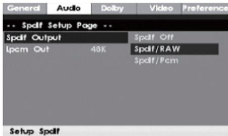
**Spdif Setup** — Настройки цифрового аудиовыхода. Выделите данную строку и нажмите кнопку ENTER, чтобы перейти в дополнительное меню. Если используется аналоговый аудиовыход, в строке Spdif Output (Цифровой аудиовыход) выберите режим Spdif Off (Цифровой аудиовыход выключен). Если используется цифровой аудиовыход микросистемы, выберите Spdif/RAW или Spdif/Pcm.
