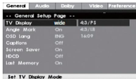
**TV Display** — Формат экрана. Установите значение 4:3/PS, чтобы выбрать формат Pan & Scan (при подключении широкоформатного телевизора, левый и правый края изображения будут обрезаны). Установите значение 4:3/LB, чтобы выбрать формат Letter Box (при подключении широкоформатного телевизора в верхней и нижней частях экрана появятся черные полосы). Установите значение Wide (16:9), чтобы использовать широкий формат при подключении широкоформатного телевизора.
