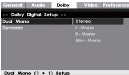
**Dual Mono** — Двойное моно. Если к микросистеме подключен усилитель или декодер, способный воспроизводить объемный звук Dolby Digital, вы можете выбрать здесь подходящий режим: Stereo (стерео), L-Mono (левый моно), R-Mono (правый моно), Mix-Mono (смешанный моно).
