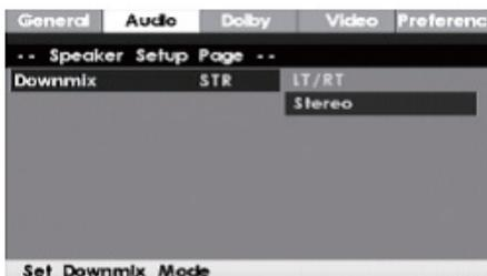
**Speaker Setup** — Настройка динамиков. Выделите данную строку и нажмите кнопку ENTER, чтобы перейти в дополнительное меню, где в зависимости от свойств диска установите подходящий режим работы динамиков: LT/RT (двухканальный) или Stereo (стерео).
