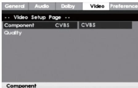
**Component** — Компонентный видеовыход. Данная настройка недоступна, т. к. микросистема имеет только один композитный видеовыход.
