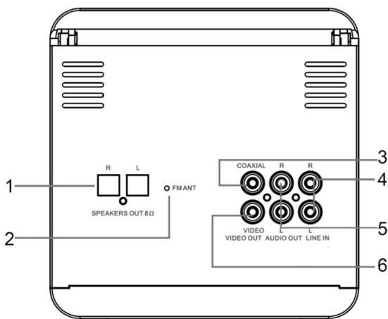
1. **SPEAKERS OUT (R-L)** Аудиовыход для подключения акустических систем
