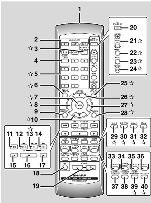
Функции кнопок, отмеченных на рисунке значком "☆", доступны только с пульта дистанционного управления.
