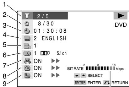
**BITRATE** показывает скорость передачи данных на аппарат в мегабитах в секунду. Однако, качество изображения не всегда пропорционально скорости передачи данных.
