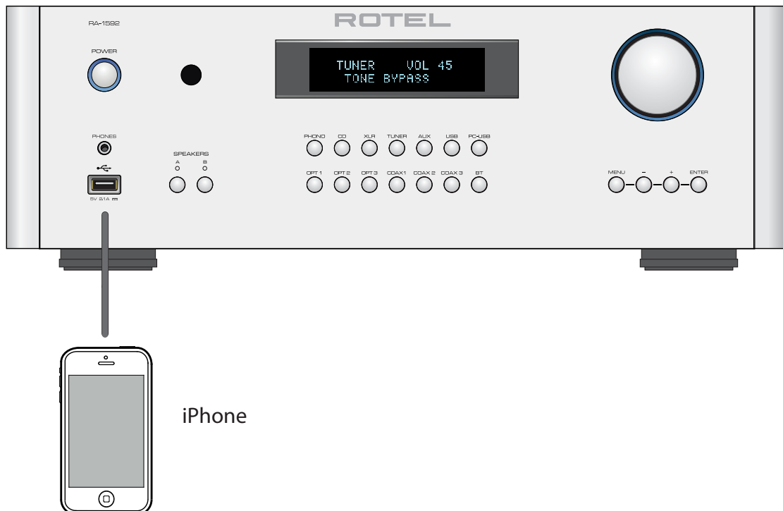
Figure 6: Front USB Input Entrée USB en face avant Frontseitiger USB-Eingang Entrada USB Frontal
