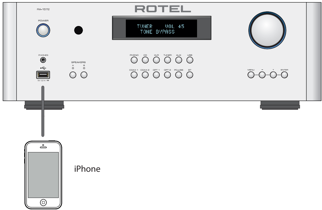
Figure 6: Front USB Input Connection Entrée USB en face avant Frontseitiger USB-Eingang Conexión de Entrada USB Frontal
