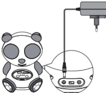
1. Убедитесь в том, что переключатель питания колонки на задней части устройства (11 на схеме устройства) находится в положении «Выкл.» («OFF»).
