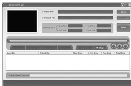
Выберите нужный файл с видео, нажав кнопку <OPEN>, затем выберите имя файла для сохранения в окошке "Output file" и нажмите кнопку <TRANSCODER>. Установки для кодирования видео уже соответствуют вашему плееру.
