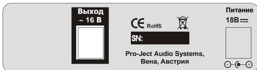
Подключите кабель питания из комплекта поставки \*\*\* (полярность --⊖⊕) к гнезду **Выход ~16В** и к гнезду блока питания проигрывателя. После этого оригинальный блок питания проигрывателя больше не требуется.
