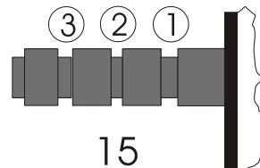
Вденьте петлю нитки груза для компенсации скатывающей силы в канавку на штыре (15) согласно прижимной силе, прикладываемой к вашей головке, и вденьте нитку в канавку на опоре для провода (17).
