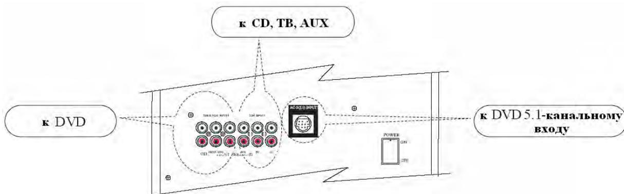
**АС-3 (5.1-канальный) терминал 1** (обозначен к DVD) предназначен для подключения 5.1-канальных устройств (таких как DVD плеер данного домашнего кинотеатра) с передними, задними, центральными выходами и выходом для сабвуфера.
