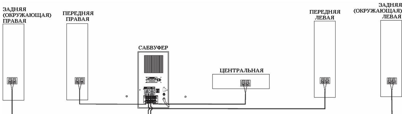
1. Подключите ПЕРЕДНЮЮ ПРАВУЮ КОЛОНКУ к переднему правому (R) выходу САБВУФЕРА (7): полосатый провод к красному позитивному (+) зажиму, а неполосатый – к черному негативному (-) зажиму.
