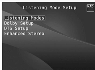
Ресивер T 757 предусматривает различные варианты режимов прослушивания, большинство из которых конфигурируемые. Режимы предназначены для обработки звука различными эффектами в зависимости от воспроизводимого источника. Конфигурирование выполняется с помощью кнопок [◀/▶] или ENTER и [▲/▼].
