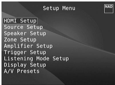
Меню настройки позволяет пользователю настроить предусилитель T 757 для работы в составе конкретной аудио-видеосистемы. С помощью данного меню Вам нужно будет произвести настройку входных разъемов предусилителя, если, конечно, Ваша система не соответствует заводским настройкам, описанным в прилагающемся Руководстве по быстрому запуску, полностью.
