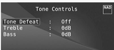
Ресивер T 757 имеет два регулятора тембра – Treble (Высокие частоты) и Bass (Низкие частоты). Регуляторы Bass и Treble затрагивают только низкие частоты нижнего диапазона и высокие частоты верхнего диапазона, оставляя важные средние частоты без изменения.
