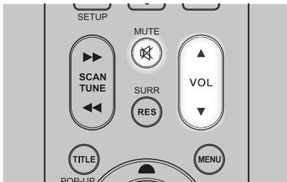
Кроме ручки громкости на лицевой панели общий уровень громкости ресивера T 757 также регулируется кнопками VOL [▲/▼] пульта ДУ AVR 4, при этом повышение и понижение уровней каналов происходит для обоих каналов одновременно. При однократном нажатии на кнопку уровень громкости изменяется на 1 дБ. Если удерживать кнопки VOL [▲/▼] в нажатом положении, уровень будет меняться непрерывно до тех пор, пока Вы не отпустите кнопку.
