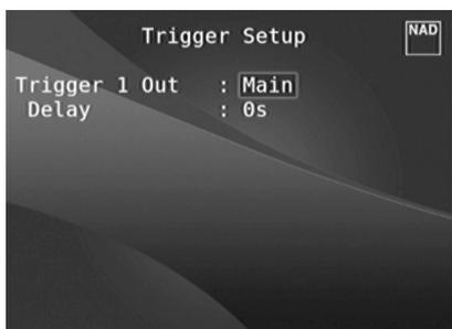
В T 757 имеется настраиваемый вывод +12 В постоянного тока, который можно использовать для активации компонента или системы, к которой он подключен. Триггеры представляют собой низковольтные сигналы, используемые для включения-выключения совместимых устройств.
