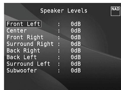
Регулировка баланса акустических систем, подключенных к вашему усилителю, обеспечивает при воспроизведении любой записи, будь то музыка или фильм, такую звуковую картину, сбалансированность эффектов, музыки и диалогов, которая была задумана изначально. Кроме того, если к предусилителю подключен сабвуфер, регулировка баланса позволяет добиться правильного соотношения уровня громкости сабвуфера и других акустических систем, и, соответственно, низких частот с другими звуковыми элементами.
