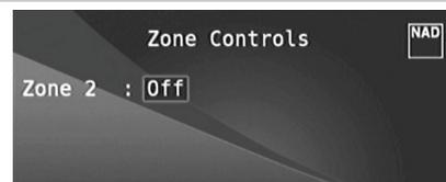
В зависимости от настроек, выполненных в меню "Настройка зон" в разделе "Меню настройки", можно сконфигурировать и осуществлять управление зоной с помощью окна Zone Controls ("Управление зонами").
