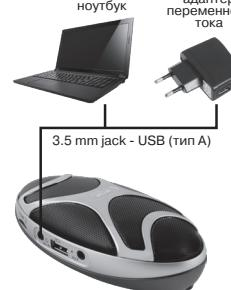
Для зарядки встроенного аккумулятора подключите аппарат при помощи прилагаемого в комплекте кабеля 3.5 mm jack - USB (тип А) к компьютеру или адаптеру\* переменного тока (220-вольт).
