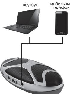
Для прослушивания музыки с внешнего источника звука подключите аппарат при помощи прилагаемого провода к стандартному 3,5-мм аудиовыходу устройства, на котором воспроизводится звуковой файл, и включите аппарат.
