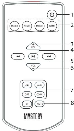
1. [⏻] Кнопка переключения между рабочим и «спящим» режимом.
