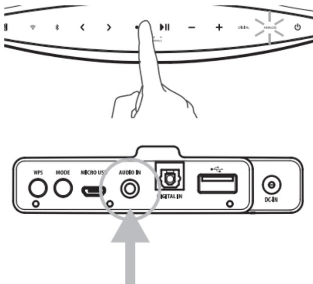
Вы можете подключить источник музыки с помощью аналогового аудио-кабеля 3.5 мм. (музыкальный плеер, ноутбук, компьютер, и т.д.).
