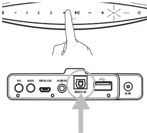
Если на источнике музыки есть цифровой аудио-выход, Вы можете соединить колонку Monster StreamCast с помощью цифрового аудио-кабеля.
