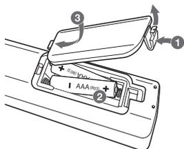
Снимите крышку отсека для батарей на задней части пульта дистанционного управления и вставьте две батареи (размера AAA), соблюдая полярность **+** и **-**.
