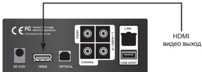
Подключите плеер к ТВ, используя HDMI кабель, переключите ваш ТВ в режим HDMI, затем настройте плеер с помощью нажатия кнопки "TV out" на пульте ДУ до появления картинки на экране.
