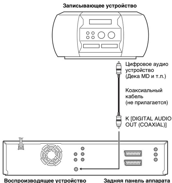
**1** Соедините аппарат и цифровое аудио устройство при помощи дополнительного коаксиального кабеля.
