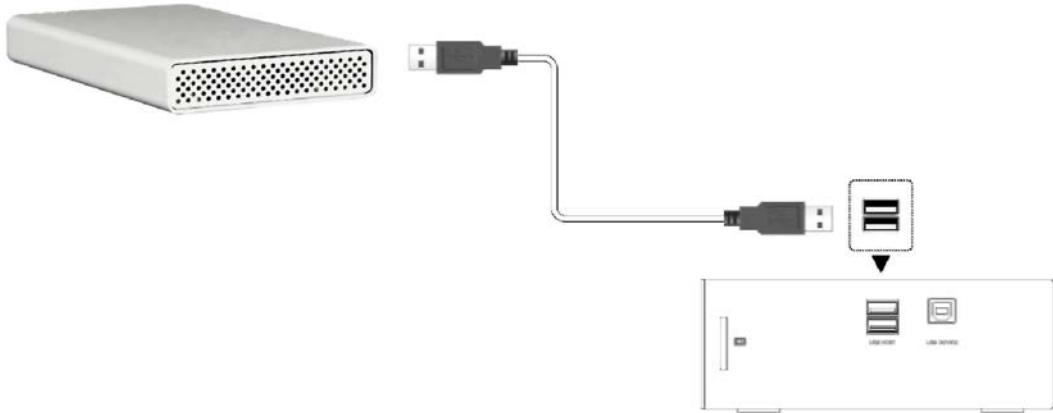
При таком подключении Вы можете просматривать содержимое устройства USB.
