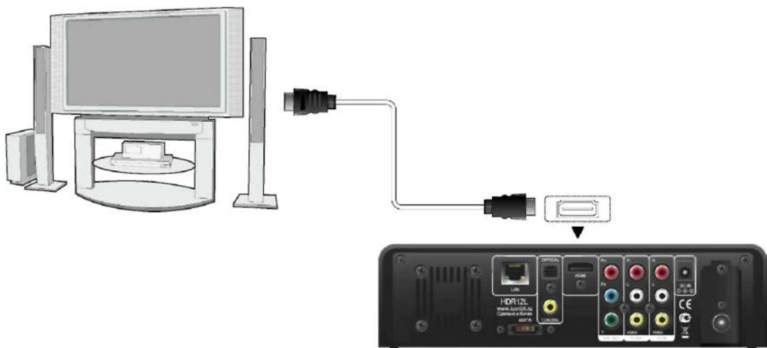
При таком подключении Вы получите самое высокое качество изображения и звука с помощью всего одного кабеля.
