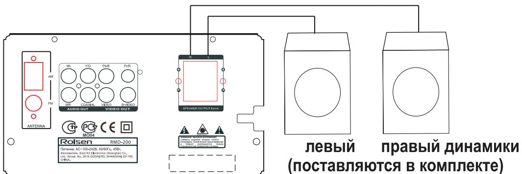
Подключите динамики к разъемам располагающимся на задней стенке микросистемы, как показано на схеме выше. Вы можете подключить, как стереодинамики, входящие в комплект, так и систему для воспроизведения объемного звука. В случае подключения системы для воспроизведения объемного звучания, настройте вашу микросистему для оптимального звучания. Настройка производится в пункте меню «настройки аудио».
