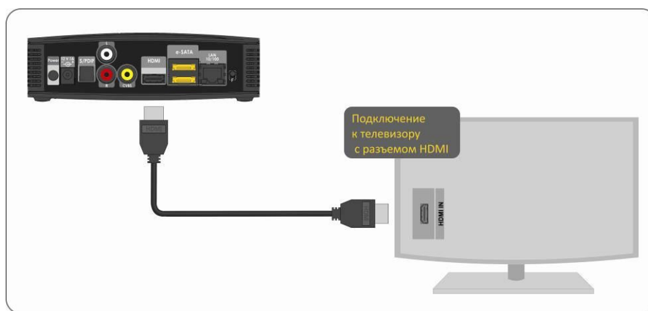
Рисунок 7 – Подключение к телевизору по интерфейсу HDMI
