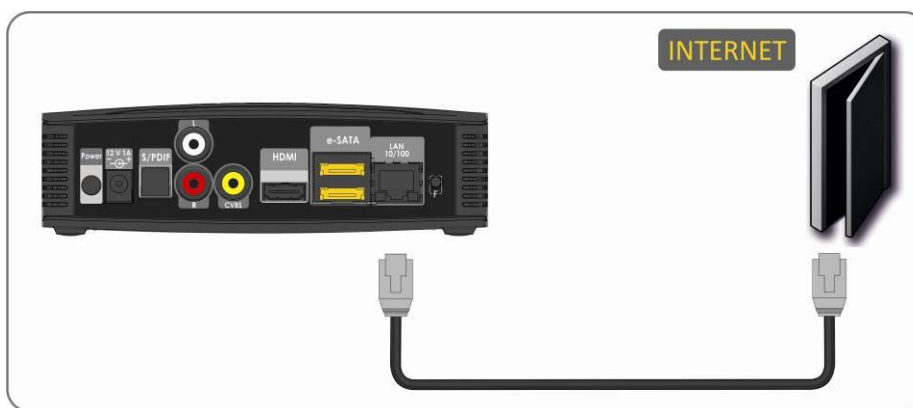
Рисунок 9 – Подключение к сети провайдера без домашнего маршрутизатора
