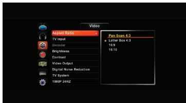
Для широкоформатных телевизоров (плазма, HDTV) используется режим "16:9 Wide". Для обычных телевизоров используются другой тип режима: "4:3 Letter Box" или "4:3 Pan Scan".
