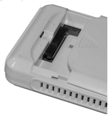
Установите внутрь 2.5" жесткий диск и плотно закройте крышку.
