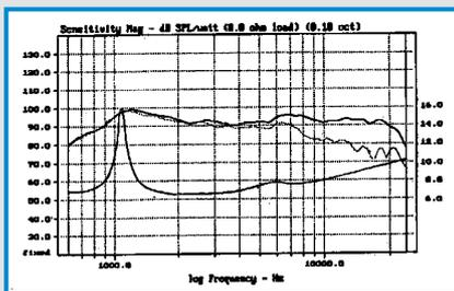
Konushochtöner, 45 mm Membrandurchmesser, beschichtete Kevlar-membran, 25-mm-Schwingspule, Phaseplug, Schaumstoffsicke, linearer Frequenzgang, hoher Wirkungsgrad, Einsatz ab 3 kHz.
