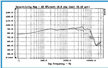
Konuslautsprecher beschichtete Kevlar-membran, 25-mm-Schwingspule, Phaseplug, Gummisicke, linearer Frequenzgang, sehr gutes Abstrahlverhalten, Einsatz bis 3 KHz. Gehäuse : Baßreflex 15-25 Liter.
