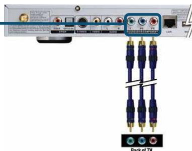
Кнопка **VIDEO OUT** на пульте ДУ переключает вывод видеосигнала между композитным, компонентным, и S-Video выходами. Если используются компонентные выходы, но они не выбраны, экран будет окрашен в синий цвет.
