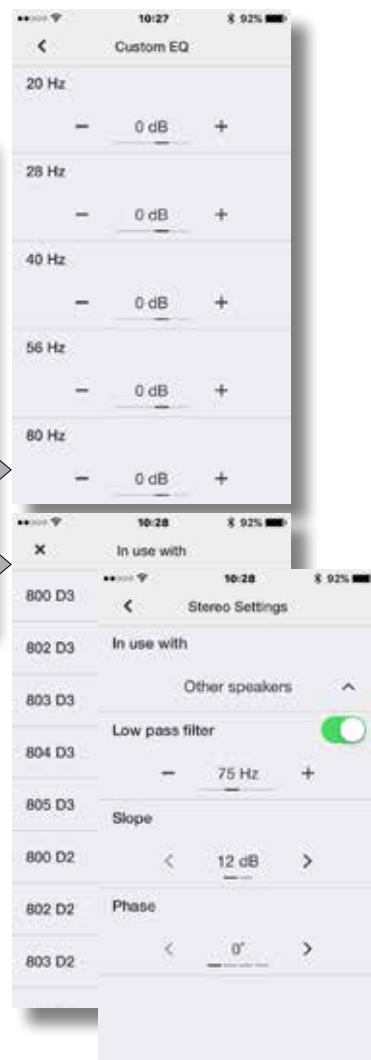
Configurações estéreo: seleção ou configuração do filtro passa-baixo.
