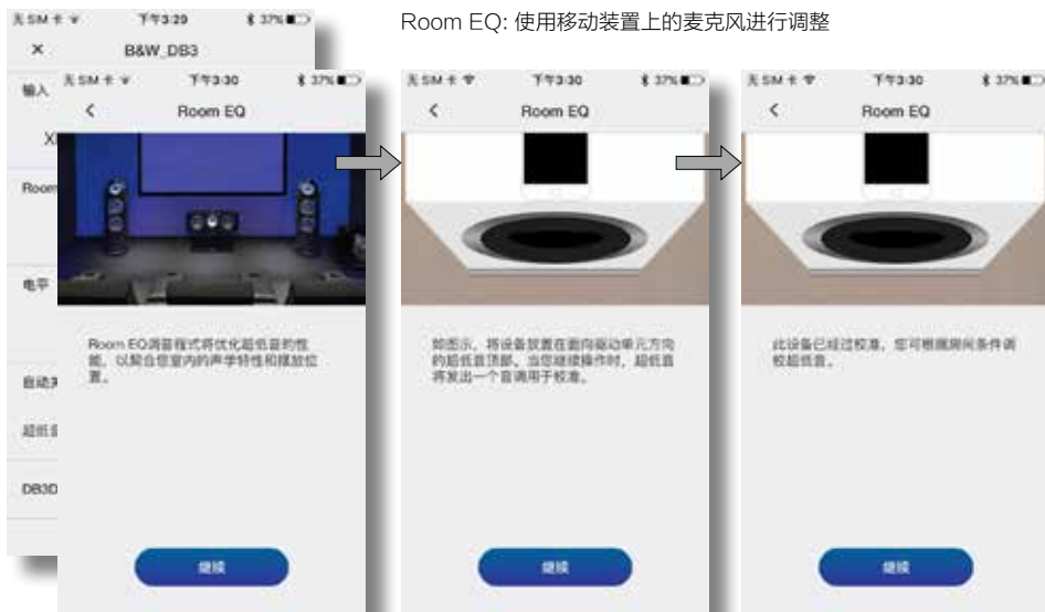
Room EQ: 使用移动装置上的麦克风进行调整
