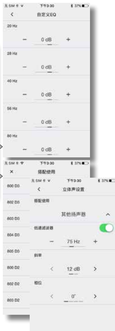
立体声设定：低通输入滤波器选择或配置
