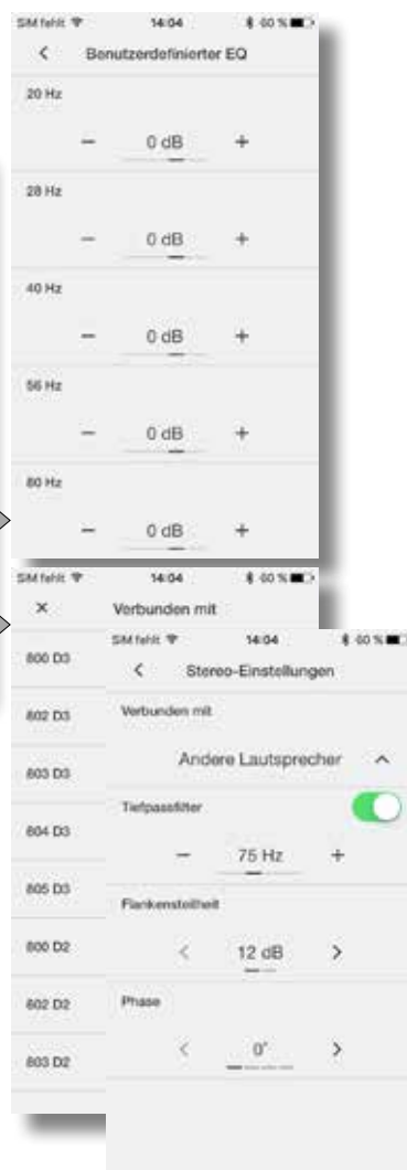
Stereo-Einstellungen: Einstellung des Tiefpassfilters bzw. Konfiguration.
