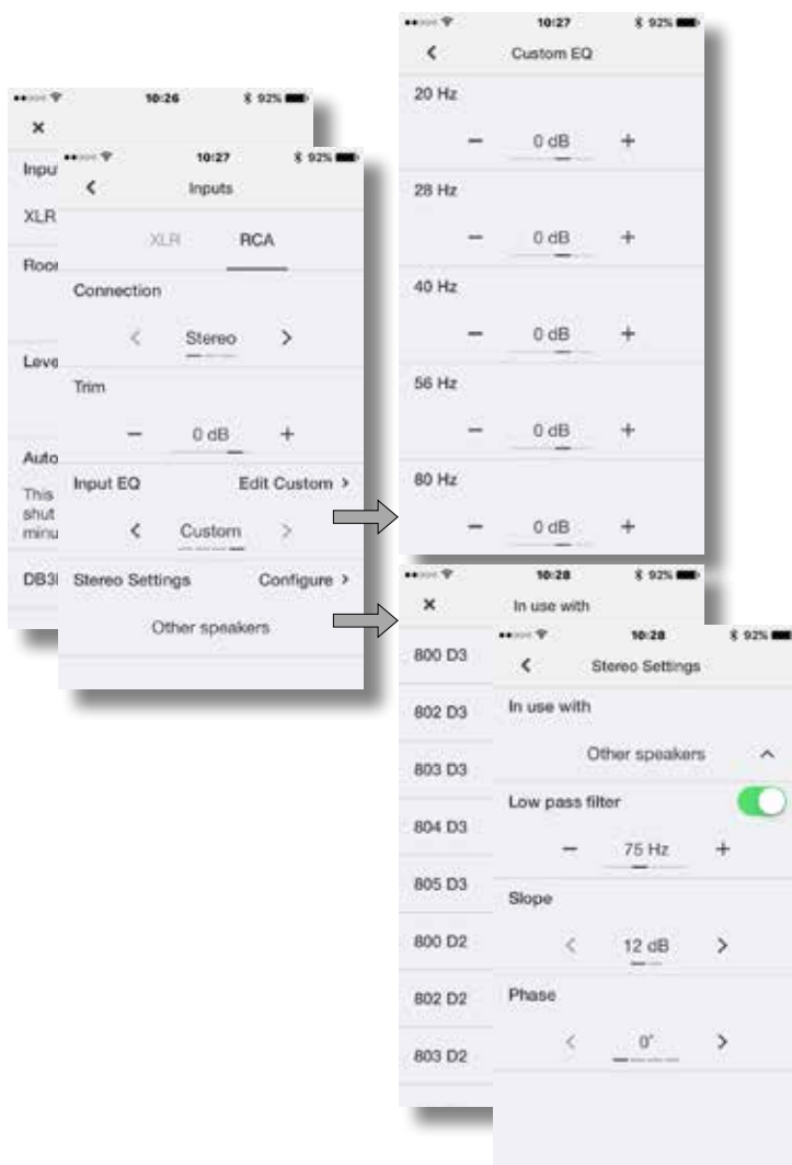
Stereo-instellingen: low-pass filterselectie of configuratie.
