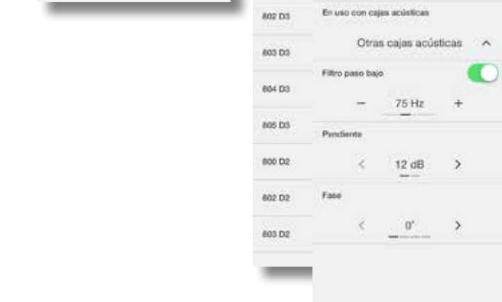
Ajustes Estereofónicos (Stereo Settings): Selección o configuración del filtro paso bajo.
