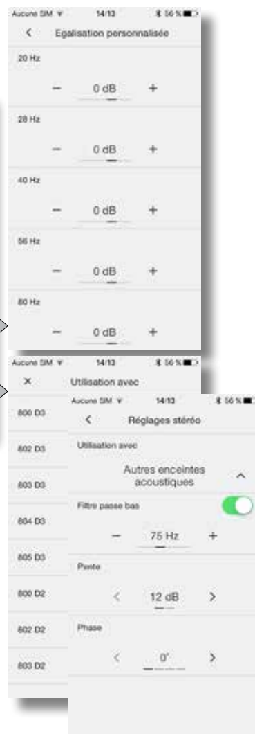
Régles Stéréo : choix et configuration du filtre passe-bas
