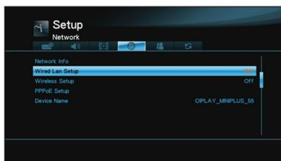
6. Выберите **ФИКС. IP (ВРУЧНУЮ)**. С помощью **кнопки навигации** введите IP адрес и маску подсети.
