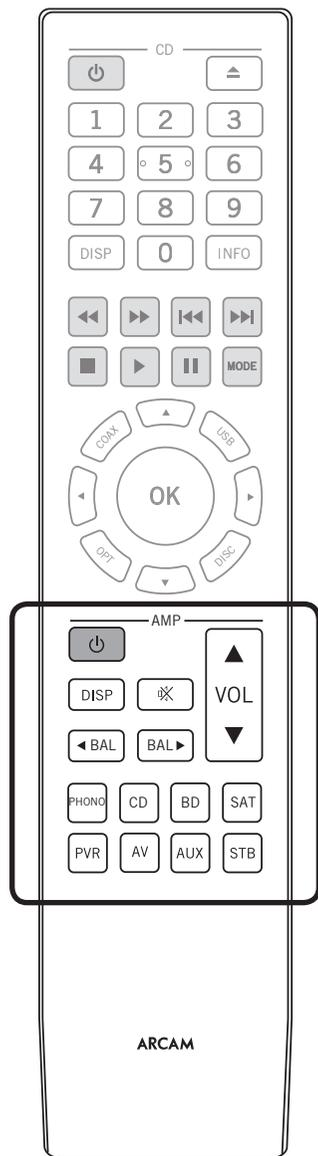
Пульт дистанционного управления запрограммирован для использования с усилителем SA10/SA20, а также CD-плеером Arcam. Информация в этом разделе относится только к секции кнопок **AMP**, которые предназначены для управления усилителем.
