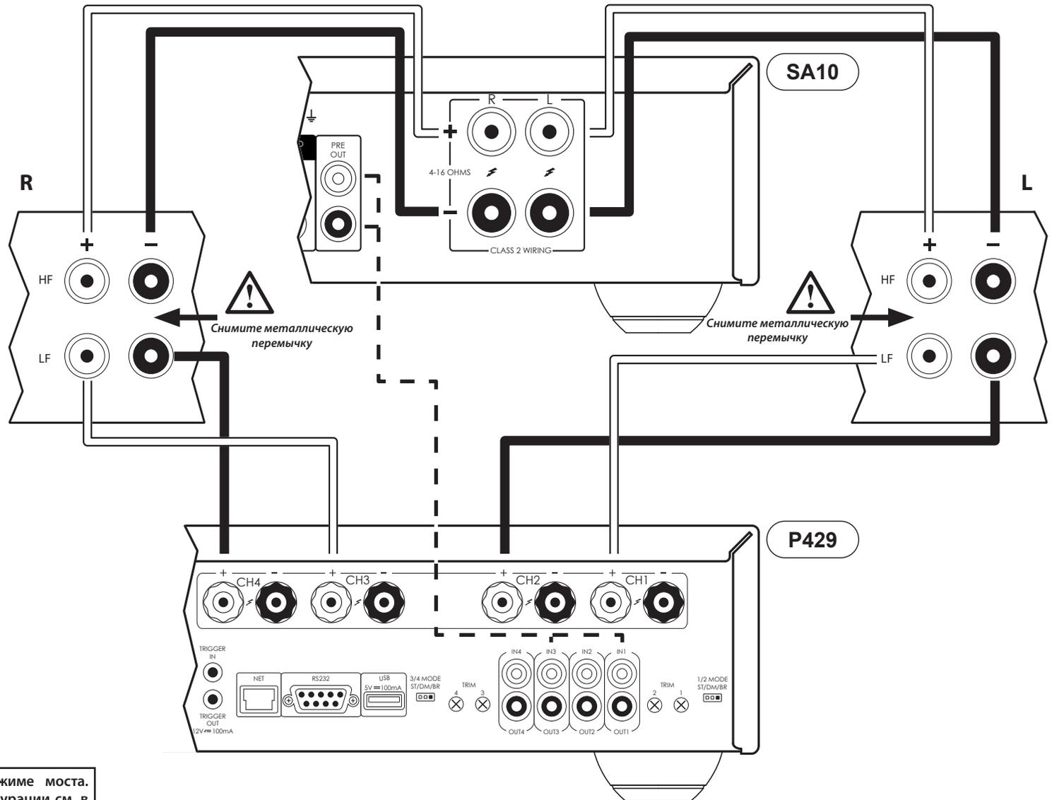
**В этом примере P429 настроен в режиме моста. Подробнее о различных режимах конфигурации см. в руководстве пользователя P429.**
