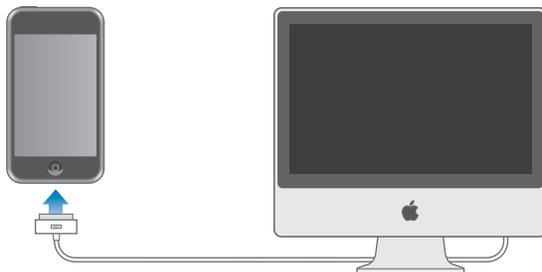
**Примечание:** Если iPod touch подключен к компьютеру, который выключен или находится в режиме сна или ожидания, аккумулятор iPod touch может разряжаться, а не заряжаться.
