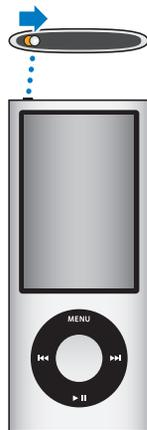
Если при использовании iPod nano элементы управления заблокированы, текущая песня, плейлист, подкаст или видео продолжают воспроизводиться, а шагомер, если он включен, продолжает подсчитывать шаги. Чтобы остановить или приостановить воспроизведение, сдвиньте переключатель «Hold» – и элементы управления вновь будут включены.
