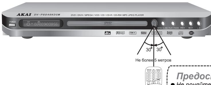
При использовании пульта дистанционного управления убедитесь, что угол отклонения пульта от воображаемого перпендикуляра к датчику инфракрасных лучей на передней панели DVD-проигрывателя не превышает 30 градусов и расстояние до проигрывателя не превышает 5 метров.
