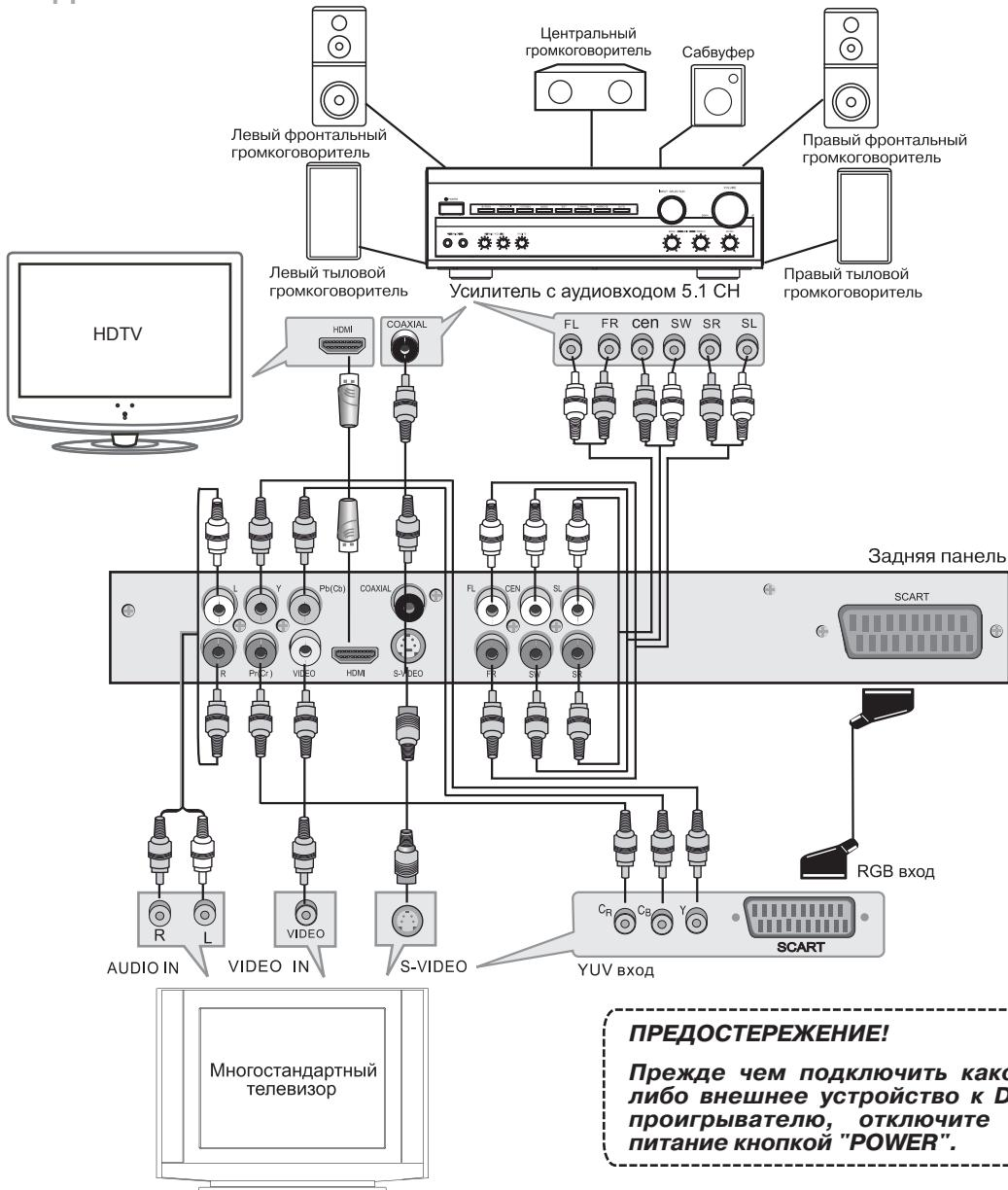
Соединительный кабель имеет цветовую маркировку аудиоразъемов, совпадающую с маркировкой разъемов DVD-проигрывателя:
