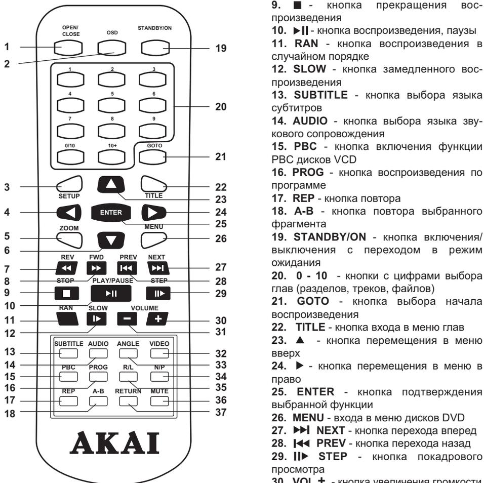
1. **OPEN/CLOSE** - кнопка выдвигания лотка для загрузки дисков
