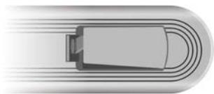
Соблюдая полярность, установите два элемента питания типоразмера AAA.
