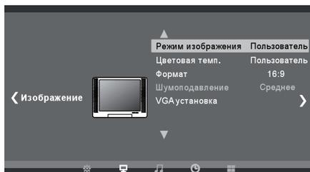
3. Используя кнопки **▲ ▼** на ПДУ или **CH+/CH-** на телевизоре, выберите **VGA установка**.
