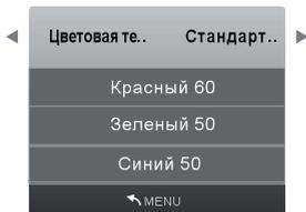
При выборе режима изображения **Пользователь** Вы можете с помощью кнопок ▲▼ (выбор параметра настройки, ◀▶ (изменение параметра настройки) изменить значения показателей цветовой температуры.
