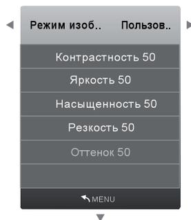
При выборе режима изображения **Пользователь** Вы можете с помощью кнопок ▲▼ (выбор параметра настройки), ◀▶ (изменение параметра настройки) изменить значения контрастности, яркости, насыщенности, резкости, оттенка.
