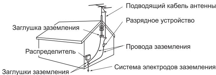
Будьте предельно осторожны при установке и подключении наружной антенны. Убедитесь в отсутствии высоковольтных линий, трансформаторов и прочих высоковольтных устройств вблизи антенны.
